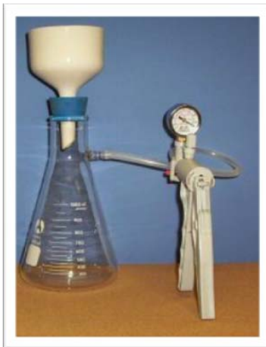
Figure 5 : Exemple du montage nécessaire à la filtration des échantillons d'eau.
